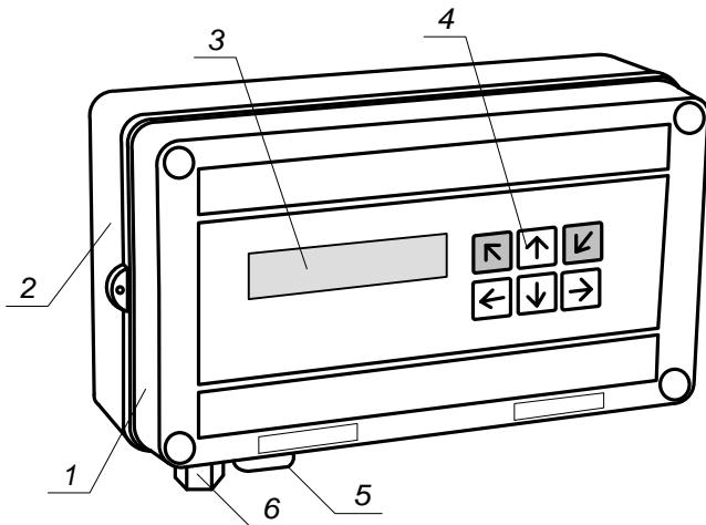
1 – модуль вычислителя; 2 – основание; 3 – жидкокристаллический индикатор; 4 – клавиатура; 5 – разъем интерфейса RS-232; 6 – гермоввод кабеля питания.
