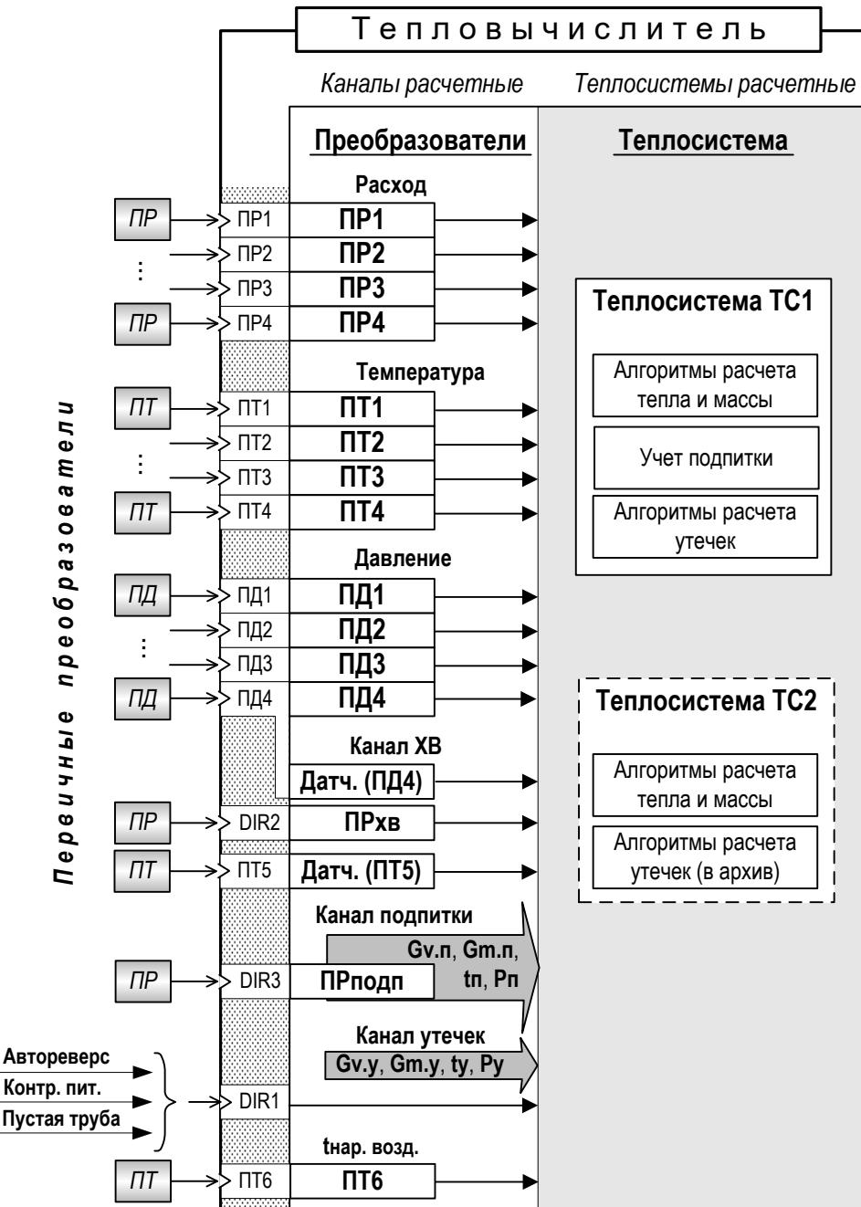
ПР, ПТ, ПД – преобразователь расхода, температуры и давления соответственно; ТС – теплосистема; Gv.p, Gv.y, Gm.p, Gm.y – соответственно объемный и массовый расход теплоносителя; tp, ty – температура теплоносителя; Рp, Ry – давление теплоносителя (p, y – индексы параметров канала подпитки и канала утечек).
