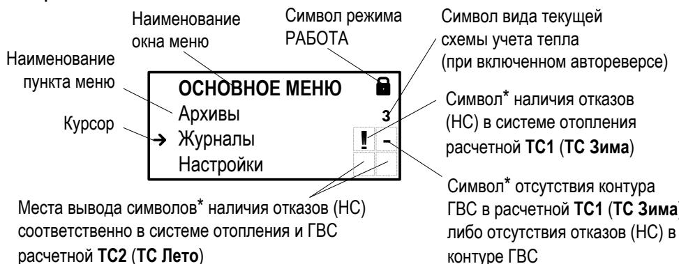
\* – вид символа также определяется установленной реакцией на возможный отказ (НС). Символы отображаются только в режиме РАБОТА.
