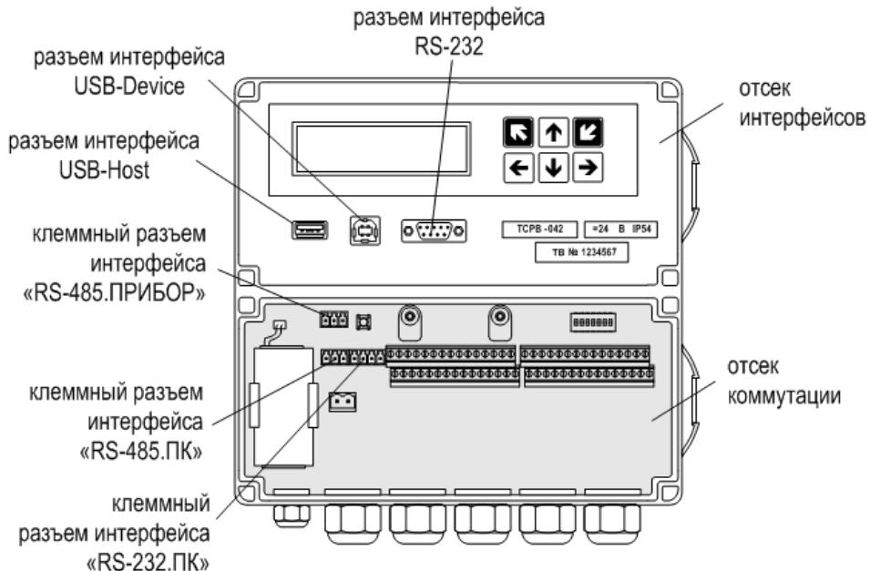
Рис.14. Размещение интерфейсных разъемов тепловычислителя.
