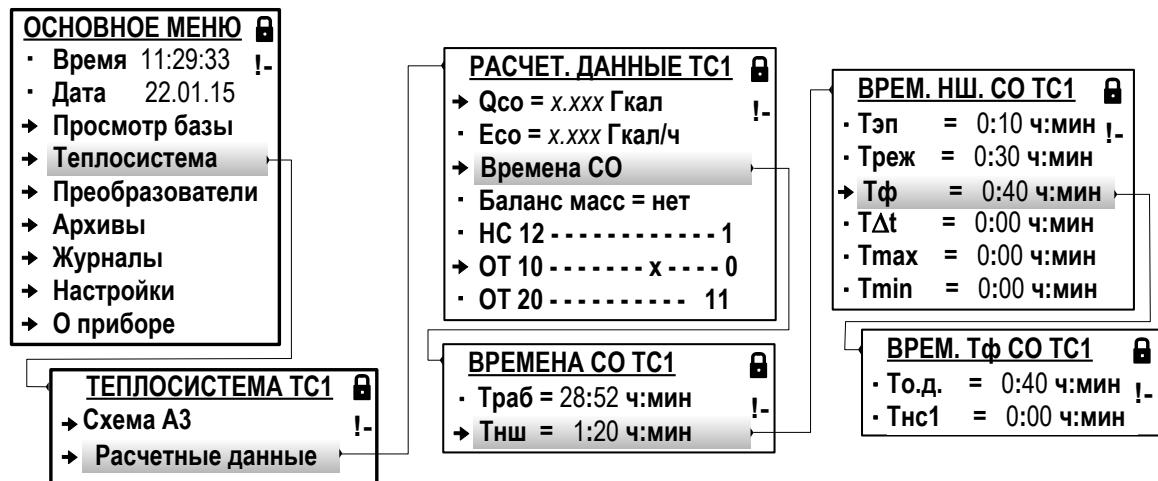
Рис.41. Вид окон индикации временных параметров в системе отопления (режим РАБОТА).
